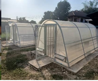
ระบบบ่อแห้งพลังงาน แสงอาทิตย์
