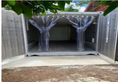
ตู้คอนเทนเนอร์ควบคุมความเย็น
